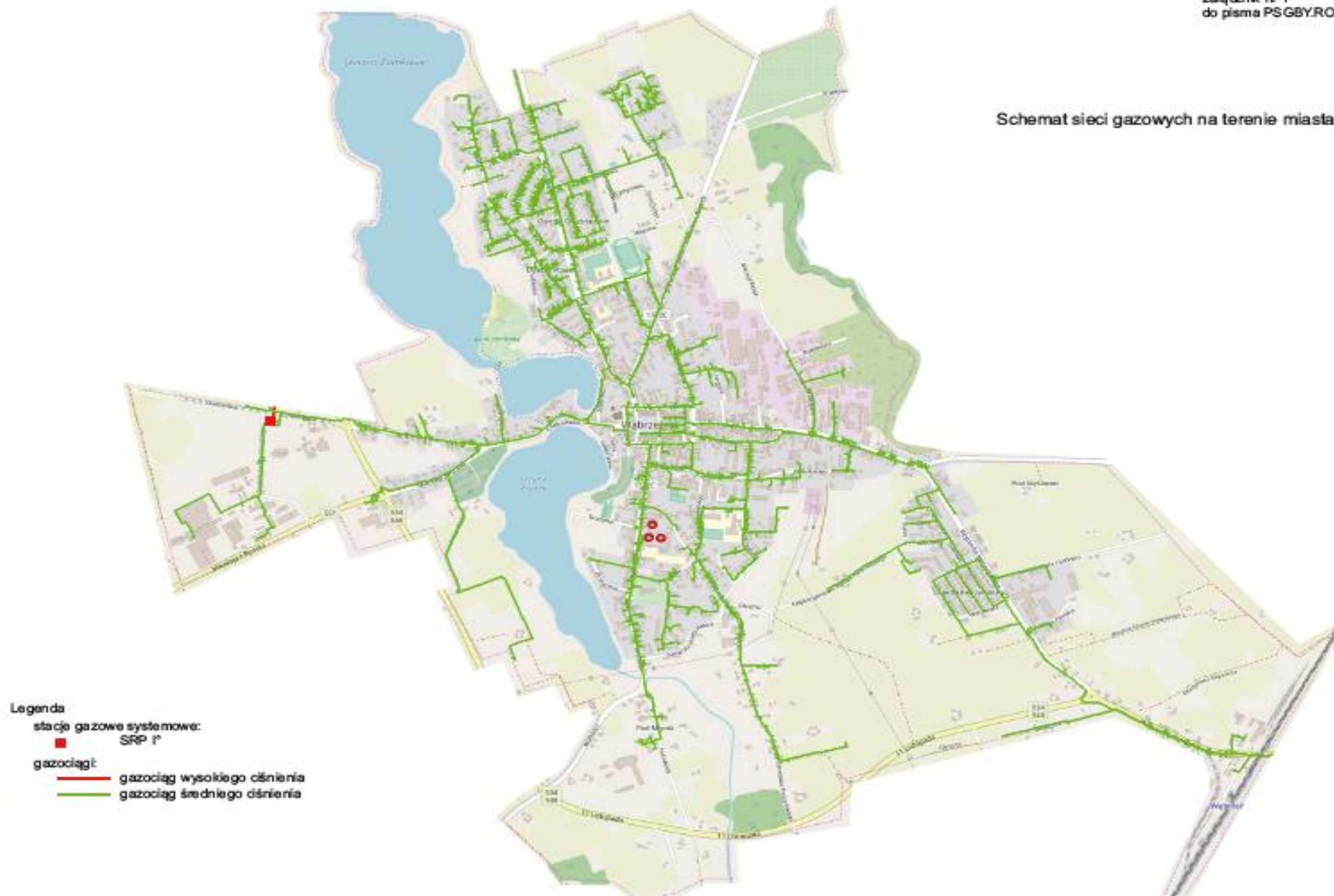
Rysunek 13 Schemat sieci gazowych na terenie miasta Wąbrzeźno [Źródło: dane pozyskane od Polska Spółka Gazownictwa Sp. z o.o. Oddział Zakład Gazowniczy w Bydgoszczy]
