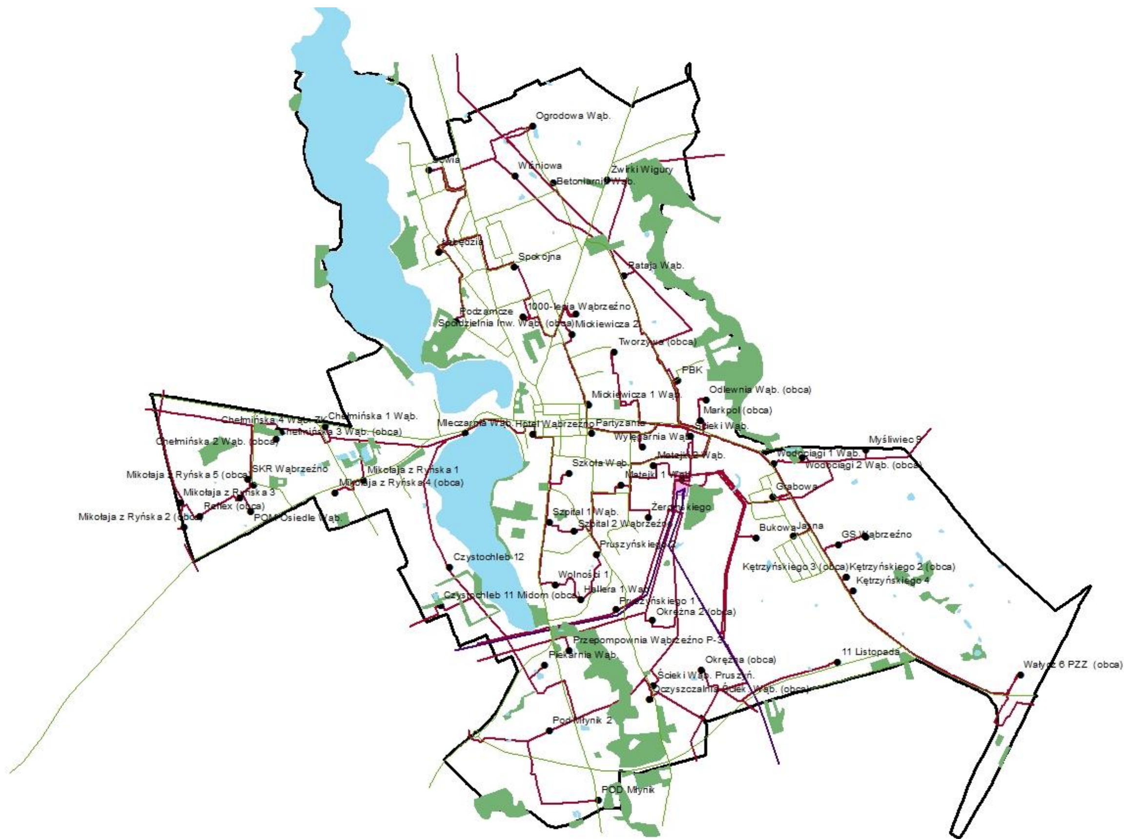
Rysunek 12 Mapa z istniejącą siecią elektroenergetyczną na terenie Gminy Miasto Wąbrzeźno [Źródło: dane pozyskane od ENERGA-OPERATOR SA].
