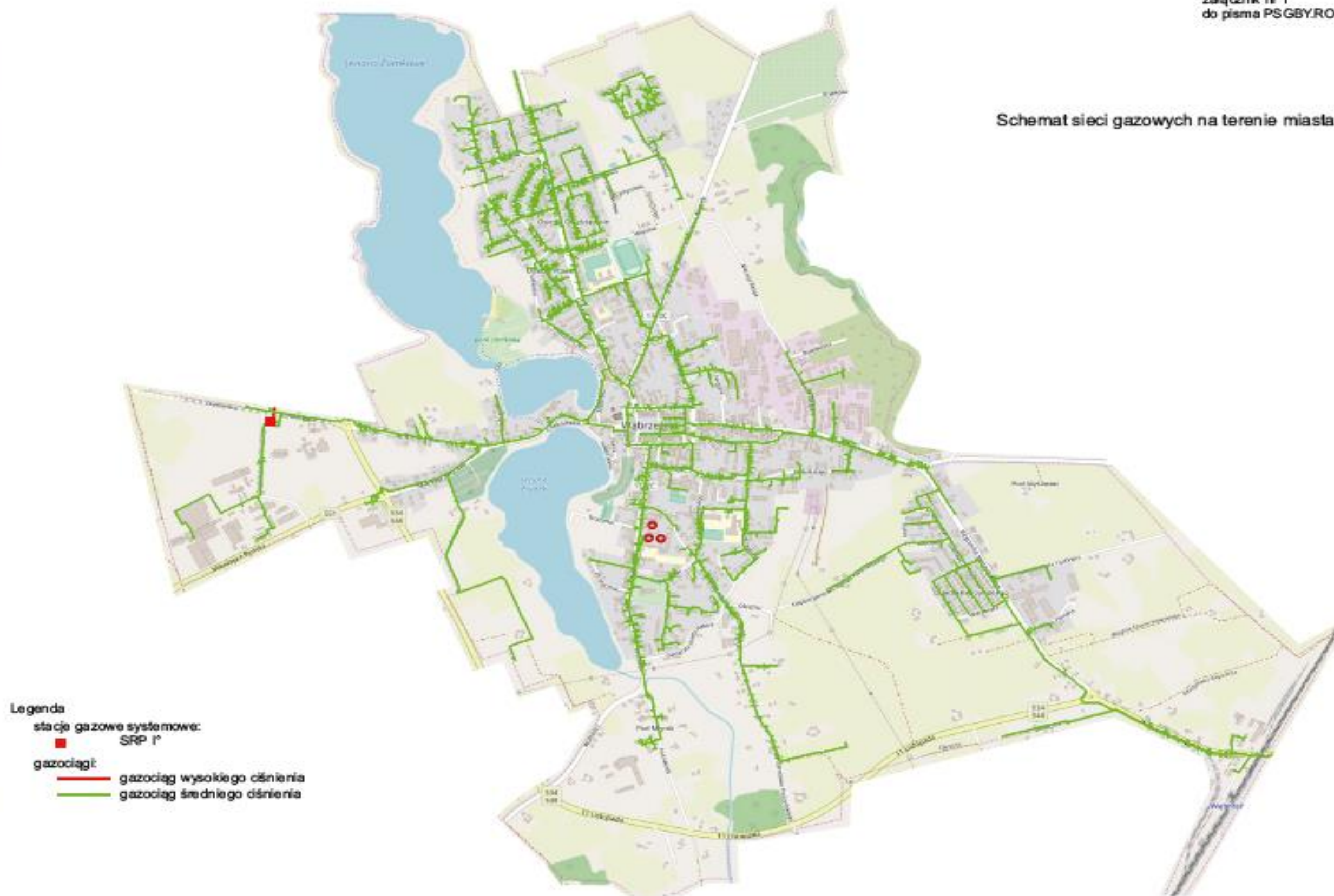
Rysunek 13 Schemat sieci gazowych na terenie miasta Wąbrzeźno [Źródło: dane pozyskane od Polska Spółka Gazownictwa Sp. z o.o. Oddział Zakład Gazowniczy w Bydgoszcy]
